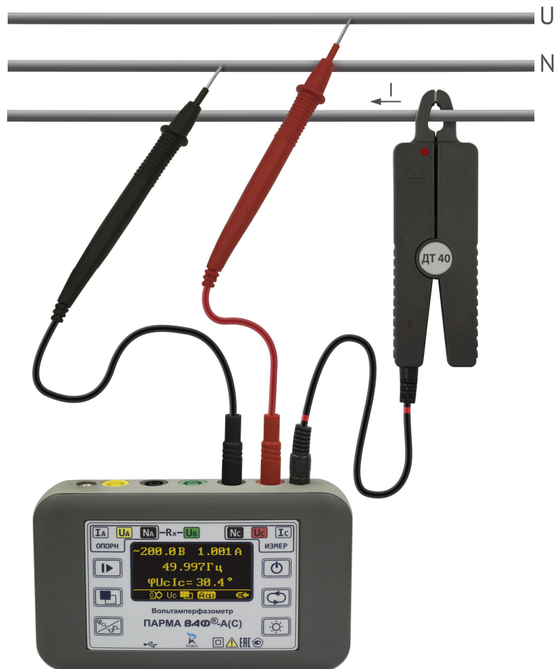
Рисунок 14 Схема подключения для измерения мощности
