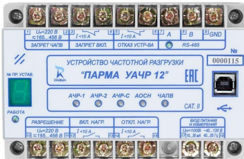
Рисунок А.1 – Нумерация клемм УАЧР
