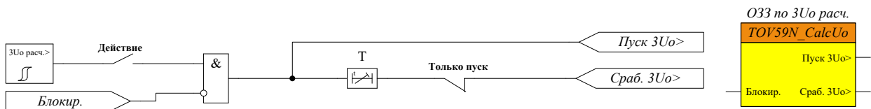
Рисунок 68 – Функциональная схема блока защиты от O33 по 3Uo расчётному
