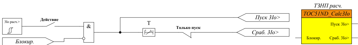
Рисунок 69 – Функциональная схема блока ТНЗНП по 3Io расчётному
