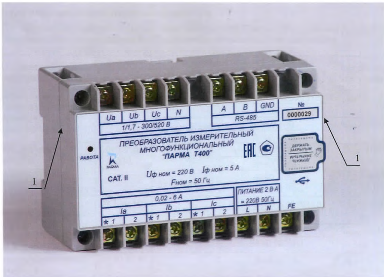
Рисунок 1 – Внешний вид и схема пломбирования от несанкционированного доступа (1 – Место для нанесения оттиска клейм)
