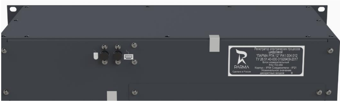
Рисунок 2а – Внешний вид задней панели блока измерительного при одностороннем исполнении
